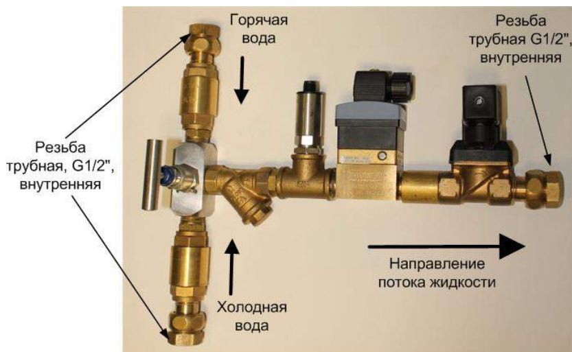
Рис 2: Подключение к магистралям холодной и горячей воды
